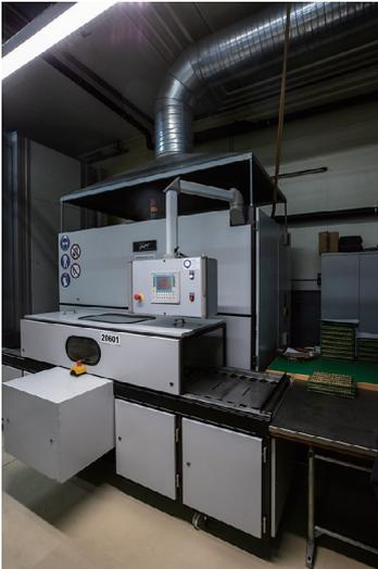
プレスで打ち抜かれた厚さ4mmのブランクは、焼き鈍しを加えて、プレス時に加わった応力を抜いていく。切削が当たり前となった現在では、珍しい工程である。土台となるブランクから歪みを取った後、3.2mmの厚さに成型する。歪みのない土台が、高い信頼性をもたらす理由だ。
