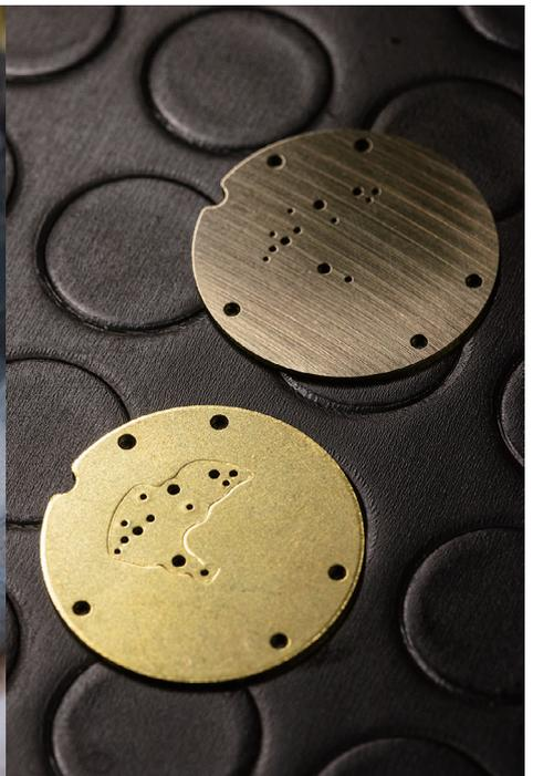
研磨の工程。プレスで成型され、穴などが加工された地板や受けは、古典的な研磨機で厚さを削っていく。(右) 手前は研磨前、奥は研磨後の地板。歪みを取った後に厚みを削るのは、部品の歪みを嫌うためだ。(中) 研磨中の部品。(左) 研磨機。部品をディスクに固定し、その上から研磨剤を混ぜた溶液をかけて上から削っていく。かつてのエポッシュメーカーには見られた機械が、まさか最新の機械を導入するコンセプト社で見られるとは思ってもみなかった。
