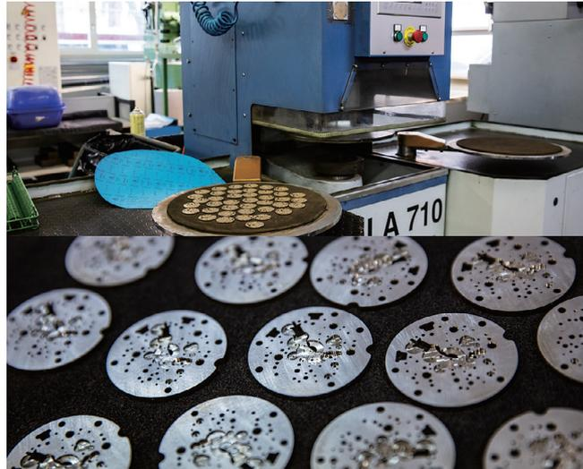
(上) コンセプト社では、ムーブメントの土台となるブランクを自社で製造している。ブランクをプレス機で打ち抜くという作業が、すべての基礎となる。後に穴開けされた地板や受けは、バレル研磨でバリなどが落とされる。(下) 仕上がりが状態の地板。価格帯を問わず、コンセプトは最新の工作機械で穴開けなどを行う。そのため、価格帯にかかわらず、部品の精度は高い。同社のムーブメントが、ルイ・モネのような少量生産メーカーだけでなく、ブライトリングやジンといった大メーカーに好まれるのも納得だ。
