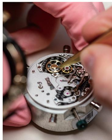
ルイ モネのクロノグラフは、例外なくクロノグラフ秒針の先端が曲げられている。普通は曲げられた状態で納品されるが、ルイ モネでは時計師が組み立て時に自ら曲げて装着する。実演してくれたのは12年の経験を持つ時計師だ。「曲げられれば、やり方は何でも良いのです。同じ曲面のカーブを付けられるよう、彼女はプラスチックの丸棒を当てるといったテクニックを身につけたのです」(マシュー・ピン)。必要な条件は、完全に傷を付けないこと。「さまざまなムーブメントを経験できるのが、ルイ モネの組み立てに携われる面白さですね」と、ルイ モネのムーブメントの組み立て・調整に携わる時計師は、その利点を語る。
